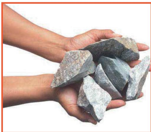
El proceso de manufactura de la lana de roca comienza con la selección y clasificación de las rocas basálticas e ígneas, las cuales se combinan y adicionan con otros minerales calcáreos y magnesio.
