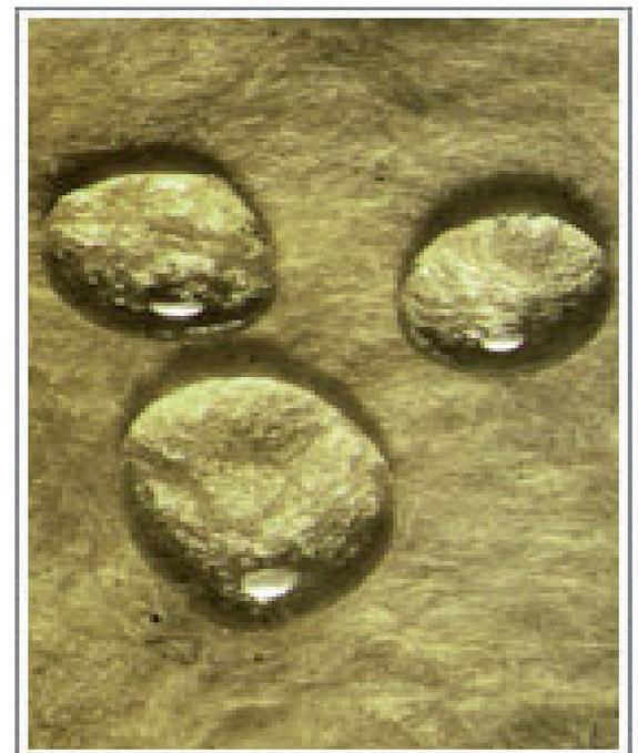
La Lana Mineral de Roca no absorbe agua por acción capilar ni aún en presencia de ambientes con elevados niveles de humedad atmosférica. Si el agua llegase a penetrar y saturar el aislamiento, la Lana no sufrirá ningún daño funcional y las propiedades aislantes permanecerán inalteradas después de seco.
