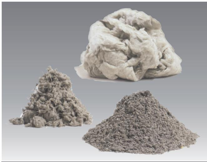
Lana Mineral de Roca en diferentes presentaciones diseñada como aislamiento termo acústico y protección al fuego, resiste una temperatura de operación de 750°C. Ampliamente utilizados como sustrato en cultivos hidropónicos.
